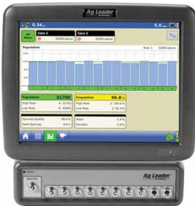
Slika 5. Kontrolni monitor s mogućnošću nadziranja rada i upravljanja priključcima.
